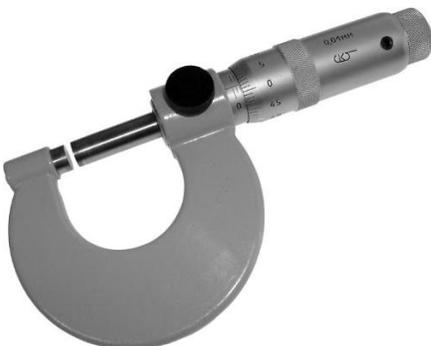
**Micrómetro o Tornillo de Palmer:** es un instrumento de medición cuyo funcionamiento está basado en el tornillo micrométrico que sirve para medir las dimensiones de un objeto con alta precisión, del orden de centésimas de milímetros (0,01 mm) y de milésimas de milímetros (0,001 mm) (micra) (figura 6).
